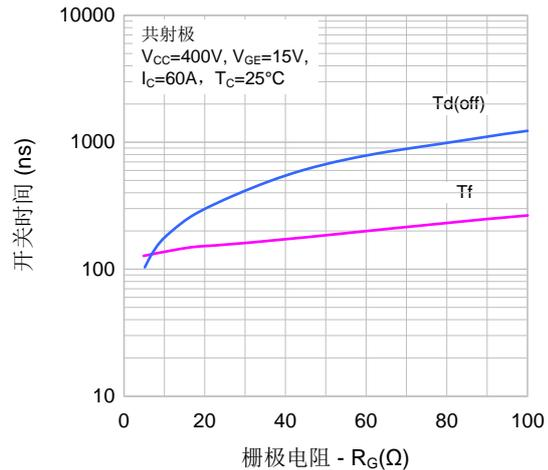
图11. 开关损耗 vs. 栅极电阻
