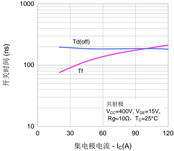
图14. 开关损耗 vs. 集电极电流
