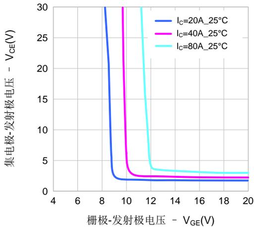
图6. 饱和电压 vs. 栅极-发射极电压
