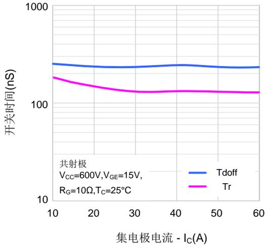
图14. 关断损耗vs集电极电流
