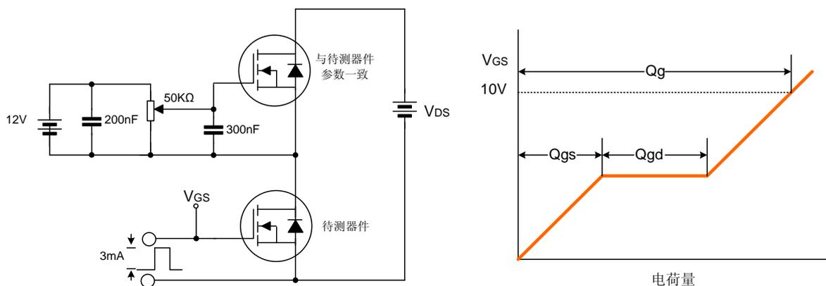
开关时间测试电路及波形图
